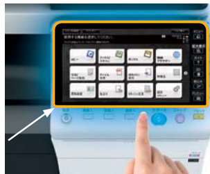
近接センサーの内蔵アンテナ
